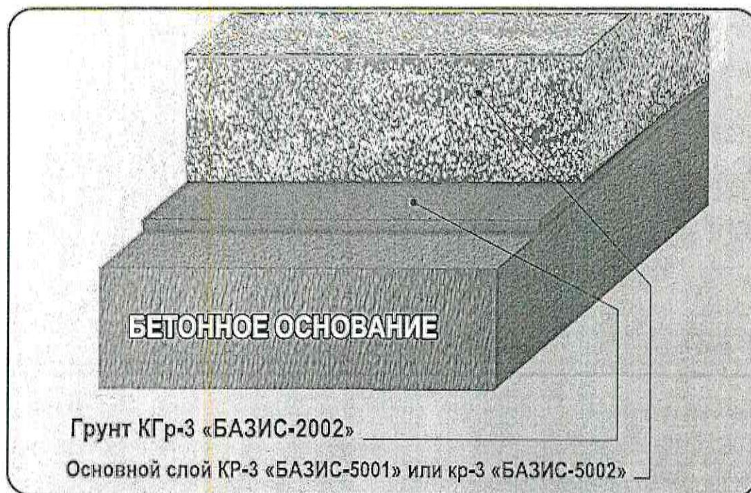
Рисунок 1 – Схема полимерминерального покрытия пола из композиции растворной трехкомпонентной КР-3 «БАЗИС-5001» или КР-3 «БАЗИС-5002»
